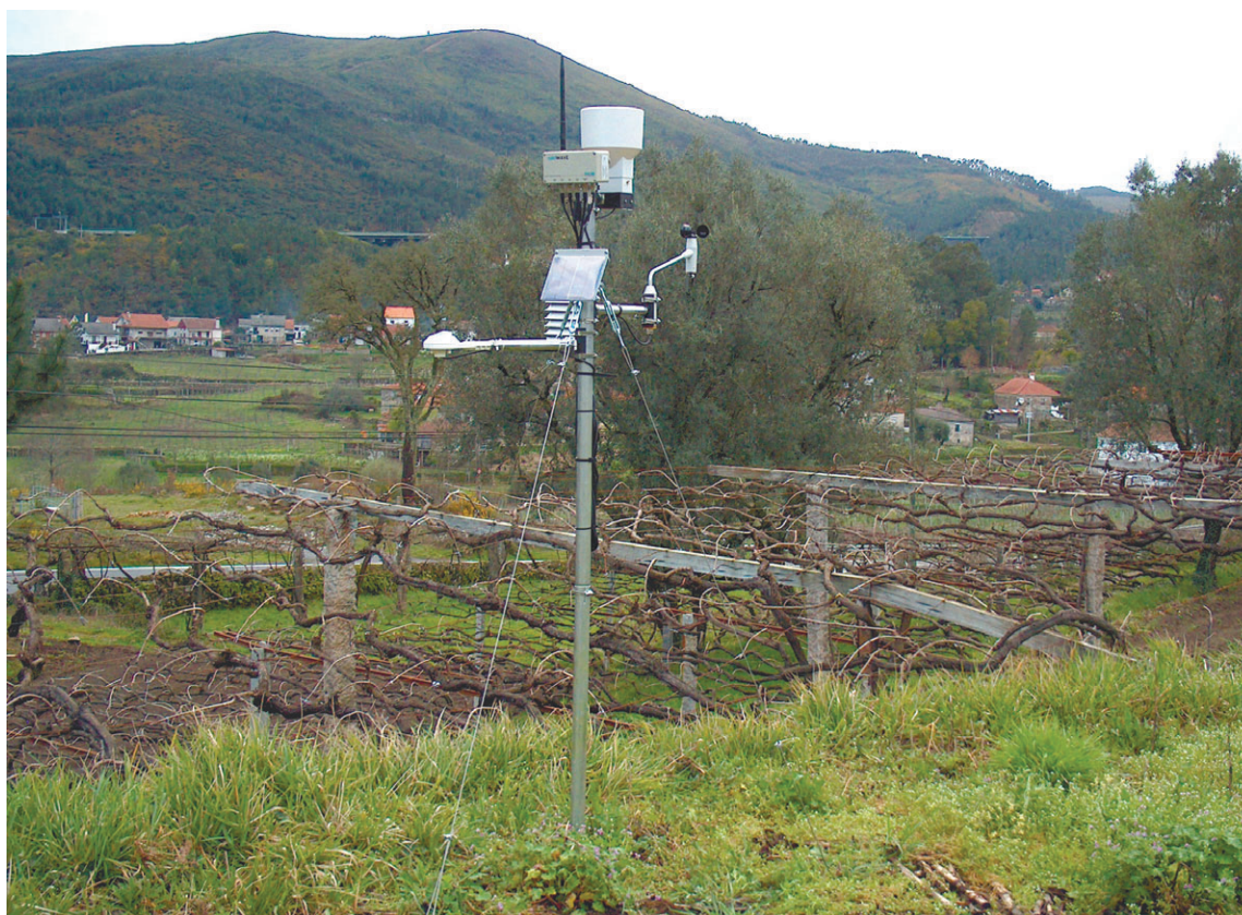
Figura 1 Estação Meteorológica Automática
